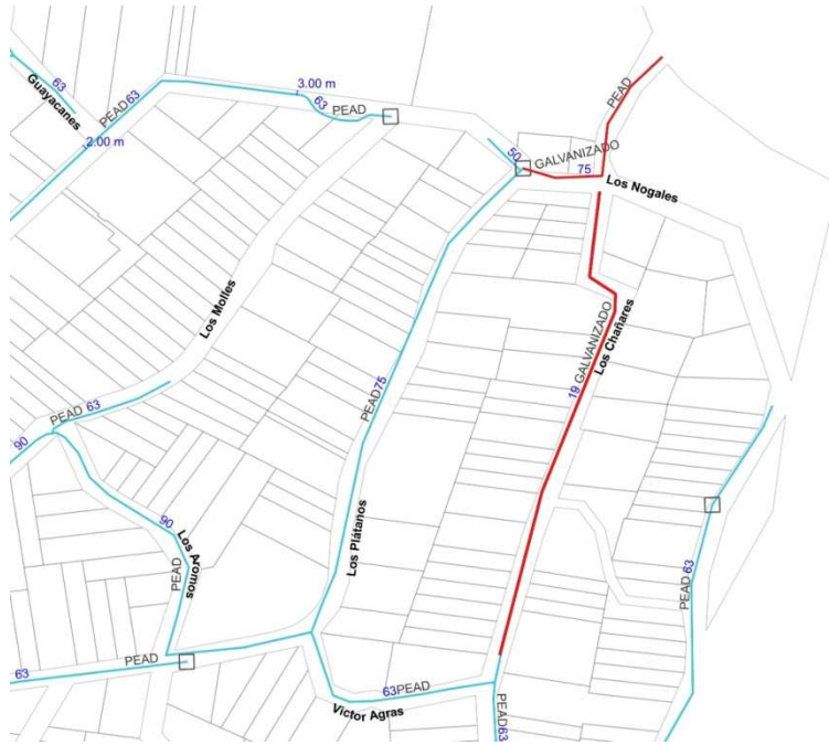
Reemplazo Cañería Calle Alzaga y Pasaje Público
